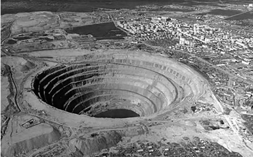
問8 資料Ⅷは、ロシアのダイヤモンド鉱山の写真です。このように坑道<sup>こうどう</sup>を掘らずに地表を掘り下げて採掘<sup>さいくつ</sup>する方法を4字で答えなさい。
